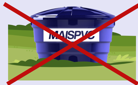
Não assente diretamente sobre o solo
